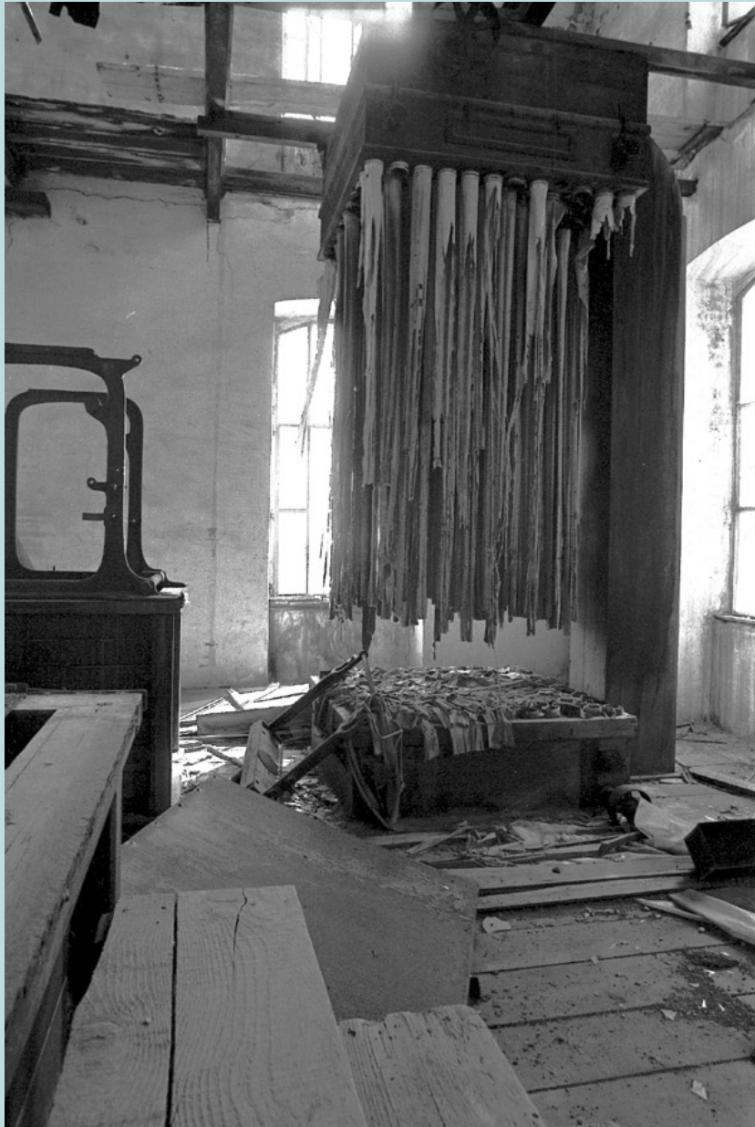
3.5 - Filtro per la pulitura del grano.
