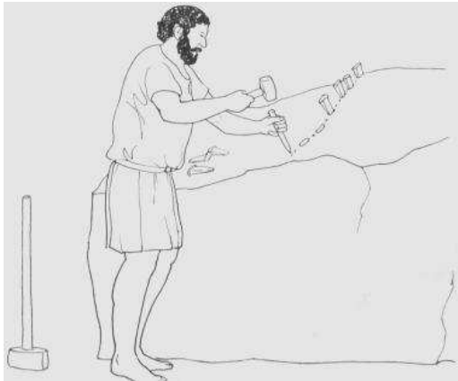
Figura 43. Fenditura di un blocco per mezzo di cunei (Fonte: Adam 2003)
