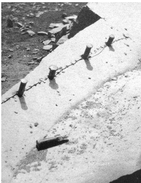
Figura 42. Linea di rottura deviata in un blocco di lava scalzato con i cunei. Terzigno (Campania).
