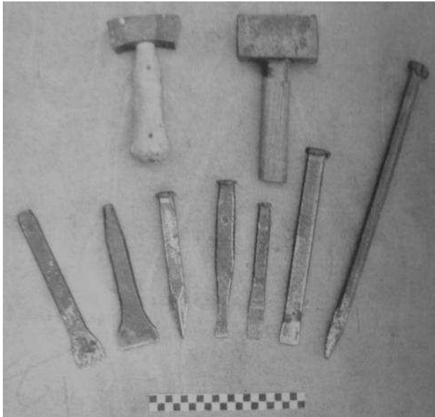
Figura 46. Principali attrezzi del tagliapietre dall'età romana al XX secolo. In alto, due mazzette. In basso, da destra a sinistra: un punteruolo, tre scalpelli, un bedano, un punzone e una gradina (Fonte: Adam 2003).
