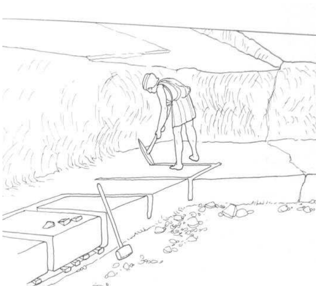
Figura 38. Coltivazione in galleria con il metodo di estrazione con cunei (Fonte: A- dam 2003).
