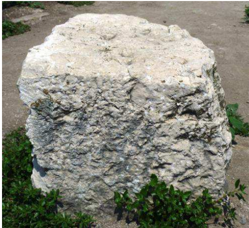
Figura 57. Blocco appena sbozzato con la martellina e il punteruolo dal cantiere del Tempio di Venere a Pompei.
