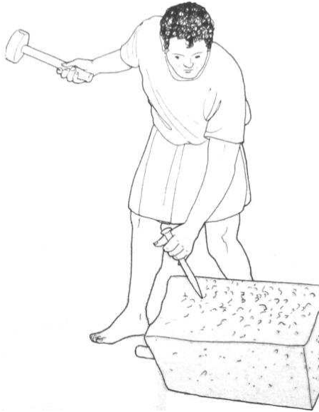
Figura 53. Tagliapietre che sta sgrossando un paramento con il punteruolo (Fonte: Adam 2003).
